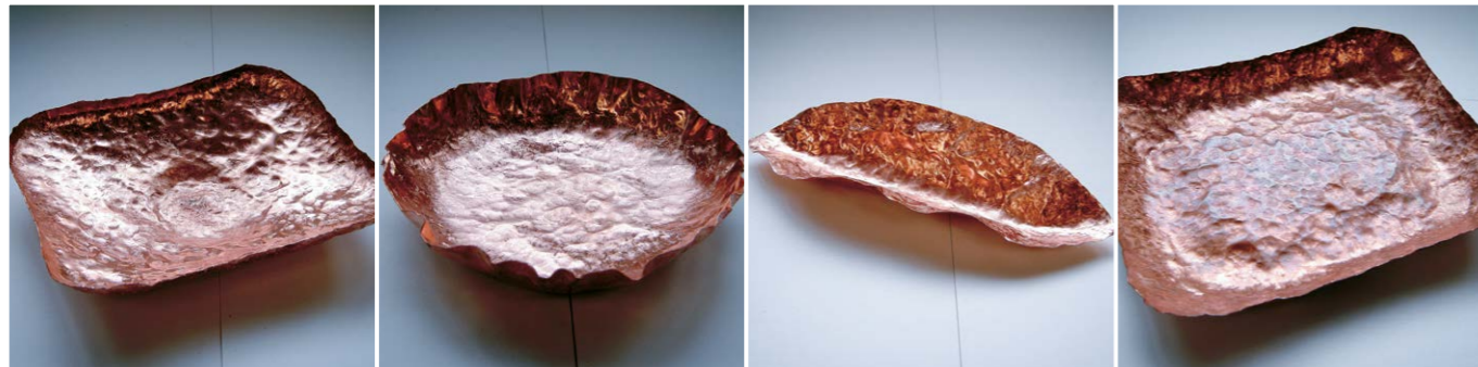
6年生 金属工作「銅板で器を作る」 薄い銅板を金槌で叩いて鍛造して器をつくります。理科で学習した【金属の性質】を実体験で応用します。
